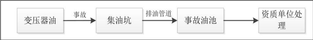
图 4-5 事故油处理流程
