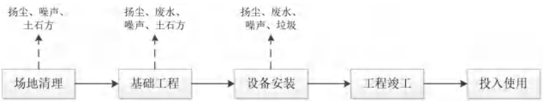
图 3.6.1-1 花椒门站及调压柜施工工艺流程示意图
