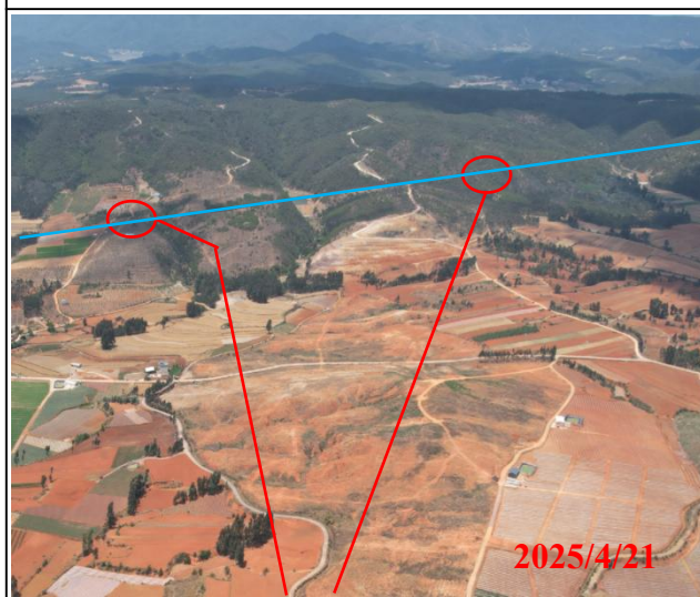
图 6 220kV 线路 \pi 接陆曲线
