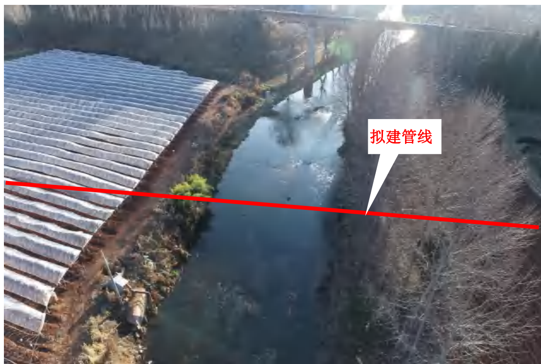
图 2.1.3-8 定向钻穿越北盘江（中型河流，河宽 20m）
