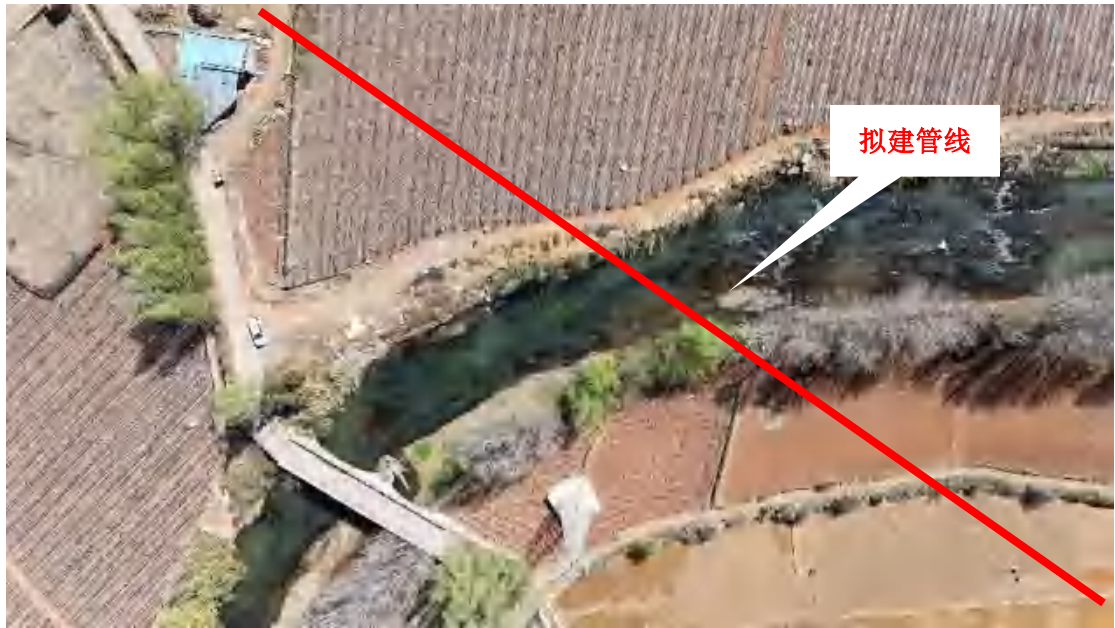
图 2.3.3-8 定向钻穿越北盘江（中型河流，河宽 20m）
