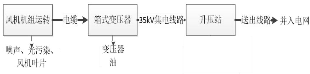
图 4-3 运营期风电场发电工艺及产污环节图
