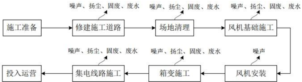
图 4-1 施工工艺流程及产污环节图
