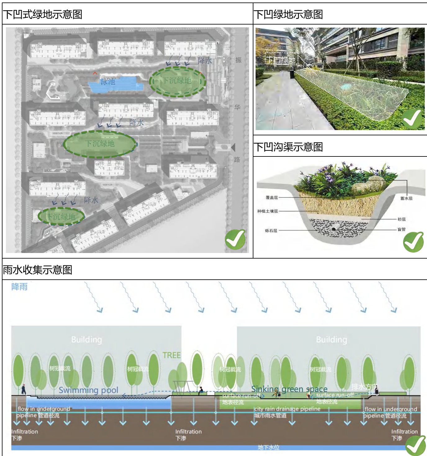
图7-2 下凹式绿地及雨水收集示意图
