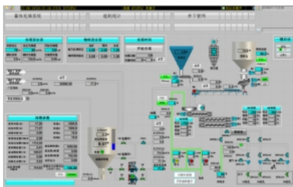
膏体充填控制系统照片
